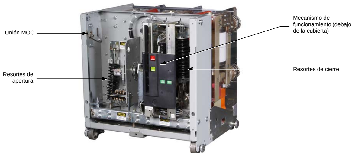
Figura 5: Interrupor automático—Vista frontal izquierda sin cubierta
